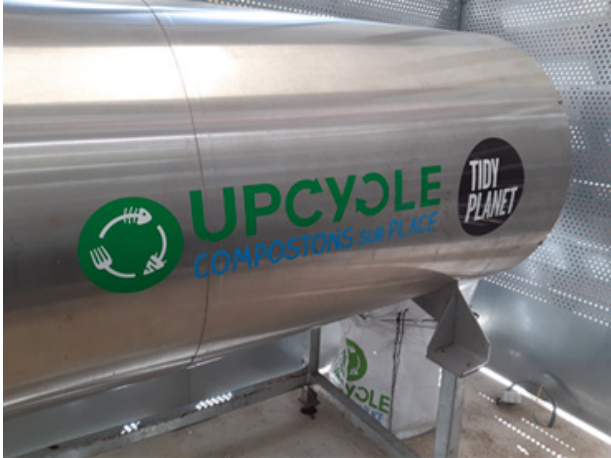
Photo : composteur électromécanique (capacité 500 kg)
